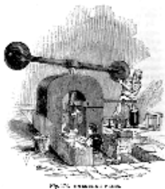
Фиг. 8. Машина за изпълнение на релефен дизайн на подвързии от 1800 г.
